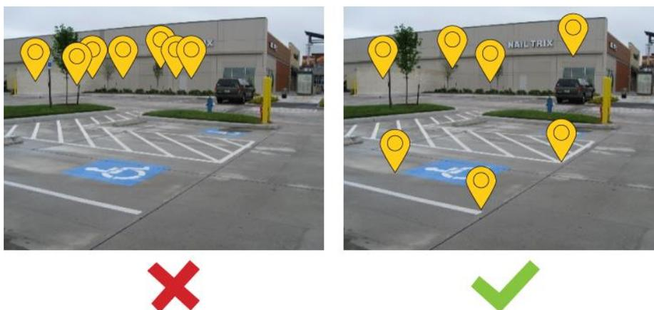
图 23: 在多个平面上测量的控制点
