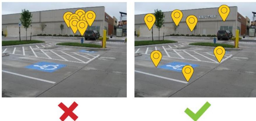
图 22: 选择良好散布的控制点
