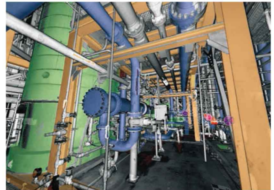
LFM 利用特有的 BubbleView™可对数据进行注释和量测。建立3D模型及模型比对。
